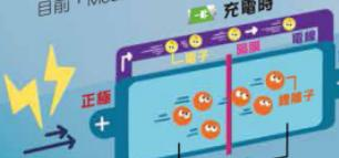
▲利用外加電場增加正極電壓，使離子和電子流向負極。
