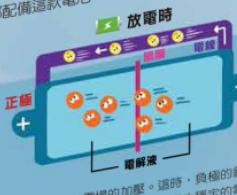
▲沒有外加電場的加壓。這時，負極的鋰離子和電子會自然流回正極，產生穩定的電流。
